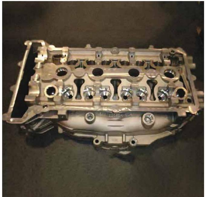
Testa cilindri - Motore Mercury Marine
